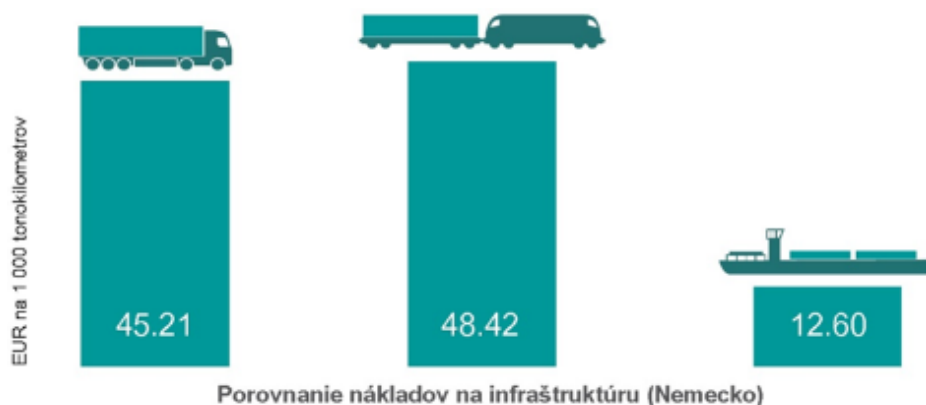
Obrázok č. 4: Porovnanie nákladov na infraštruktúru jednotlivých druhov dopravy (EUR 1000 tkm)
