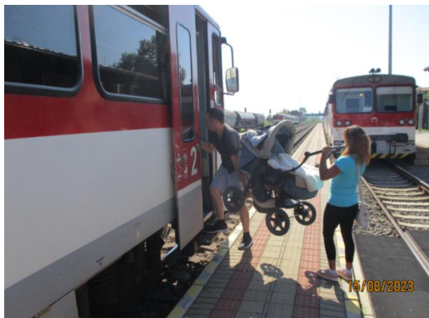
Obrázok 5: Príklad nedostatočných parametrov existujúcich nástupíšť
